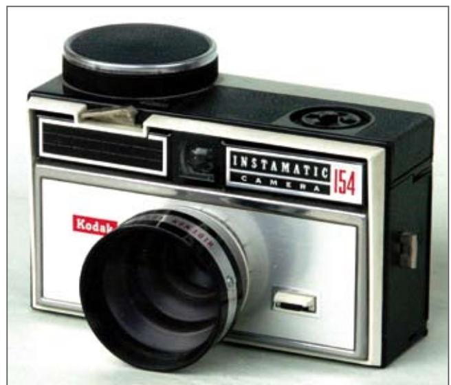
Abb. 16: Kodak Instamatic 154 mit Federwerk, hier mit Weitwinkelvorsatz
