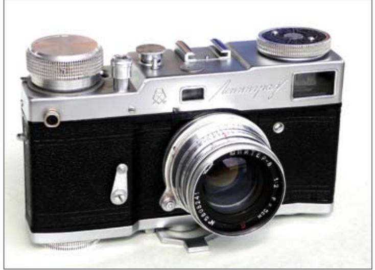
Abb. 20: Die russische Leningrad hat die Anmutung einer Contax, Wechseloptikgewinde und Schlitzverschluss wie die Leica und ein Federwerk wie die Finetta 99. Selbst der Aufzugknopf ist mit dem der Finetta 99 nahezu identisch.
