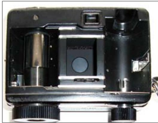
Abb. 14: Ricoh Auto Half, links die Hülse mit dem Federwerk
