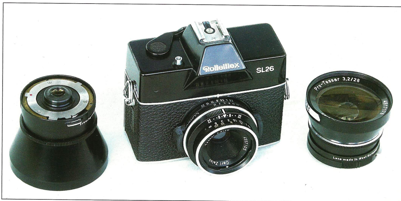
Abb. 7: Die Rolleiflex 26 fiel durch ihre kompakte Bauweise auf. Der Zwischenlinsenverschluss erforderte für Tele- und Weitwinkelaufnahmen optisch aufwändige Pro-Tessare.
