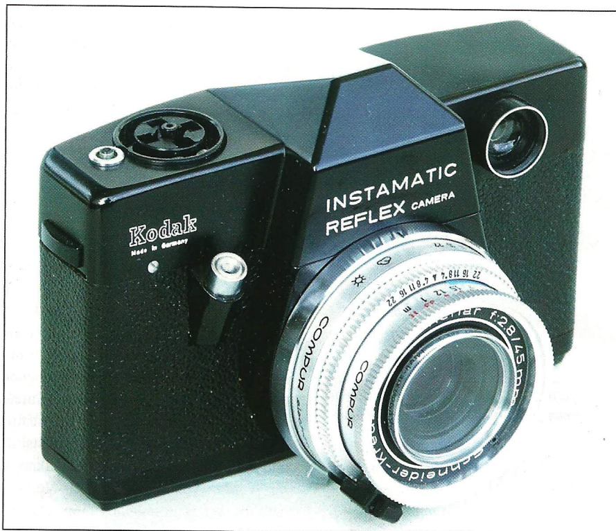
Abb. 6: Die Instamatic-Reflex, das Flaggschiff von Kodak. Das neue daran war die externe CdS-Belichtungsmessung, welche die Belichtungszeit zur vorgewählten Blende automatisch steuerte. Zusammen mit dem Xenar 2,8 war eine gekuppelte Blendensteuerung für Blitzaufnahmen mit dem Würfelblitz eingerichtet. Für das 1,9er Objektiv war dies nicht vorgesehen.
