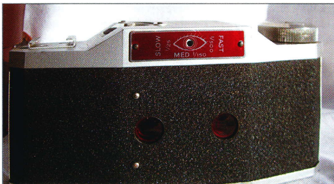
Abb. 5: Rückseite der Purma Plus, Vers. 2 mit zwei Rotfenstern
