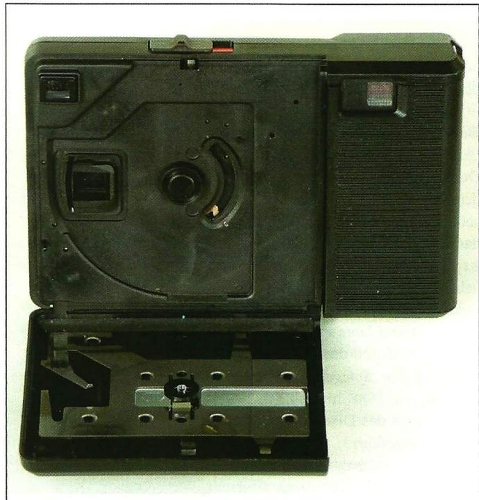
Abb. 15: Die Innenkonstruktion der Osram Flash-Disc Auto ist mit der von Kodak-Disc-Kameras nahezu identisch. Die Rückwand wird mit einem Schieber geöffnet.
