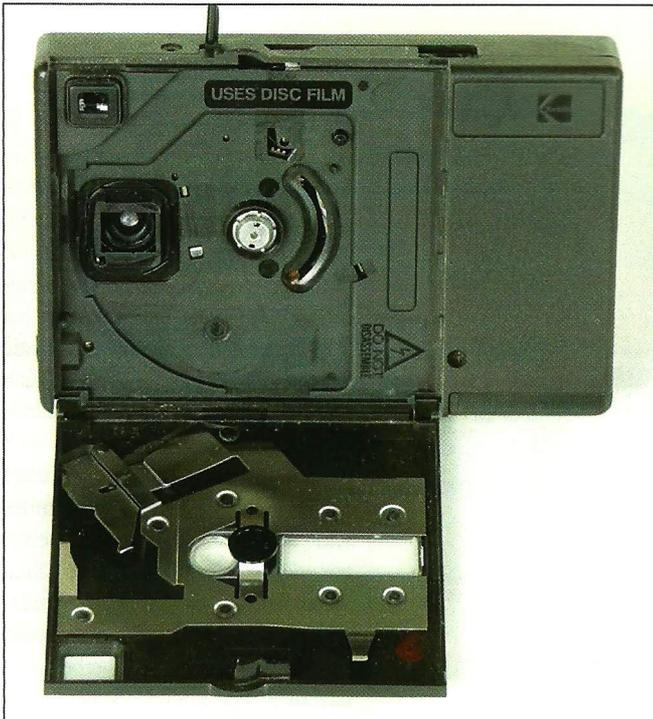
Abb. 14: Die aufwändige Innenkonstruktion einer Kodak Disc 6000, die Rückwand wird mit dem Hebel oben geöffnet.
