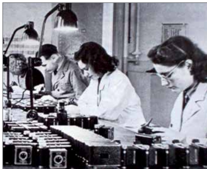
Abb. 14: Montage der Venaret
